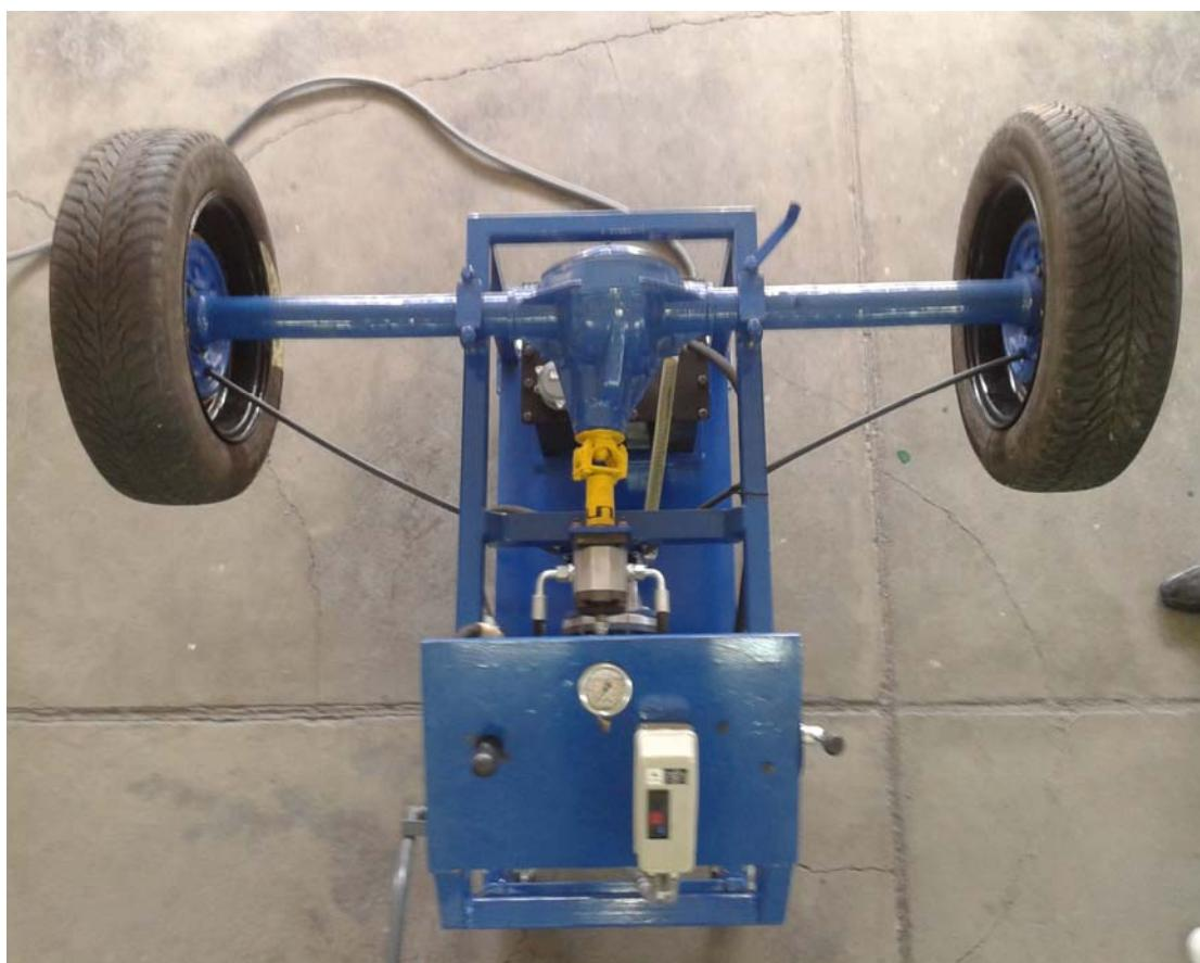
**2. ΠΕΙΡΑΜΑΤΙΚΗ ΤΡΑΠΕΖΑ ΔΟΚΙΜΩΝ ΓΙΑ ΤΟΝ ΠΡΟΣΔΙΟΡΙΣΜΟ ΤΩΝ ΕΠΙΤΡΕΠΟΜΕΝΩΝ ΓΩΝΙΩΝ ΕΥΣΤΑΘΕΙΑΣ ΤΩΝ ΓΕΩΡΓΙΚΩΝ ΕΛΚΥΣΤΗΡΩΝ ΚΑΙ ΜΗΧΑΝΗΜΑΤΩΝ ΕΚΤΟΣ ΔΡΟΜΟΥ ΓΙΑ ΑΝΟΔΙΚΗ – ΚΑΘΟΔΙΚΗ ΚΙΝΗΣΗ ΚΑΙ ΕΓΚΑΡΣΙΑ ΔΕΞΙΑ ΚΑΙ ΑΡΙΣΤΕΡΑ.**
